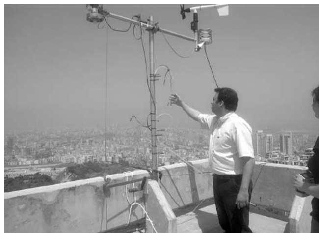
Charbel Afif montre l'équipement qui pompe les échantillons d'air pour les acheminer jusqu'au laboratoire.
